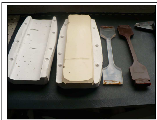
Obr. 3 - Hotové zkušební lité tyče ze slitiny AlSi (foto R. Lukůvka)
